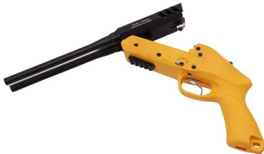
Insbesondere nach einem Tauchgang im Salzwasser ist eine Applizierung von Waffenöl (zum Beispiel „Ballistol“) nach erfolgtem Ausblasen unbedingt notwendig, um Korrosion zu vermeiden. Lassen Sie etwas Öl in die Öffnungen für die Schlagbolzen laufen, um sicher zu stellen, dass Hammer, Feder und Abzugseinheit nicht rosten. Spannen Sie die Waffe
