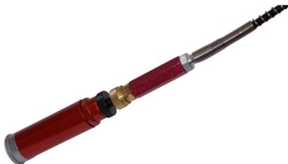
Als nächstes müssen Sie die Entlüftungsschraube des Füllgeräts schließen. Dann können Sie mit dem Füllvorgang beginnen.
