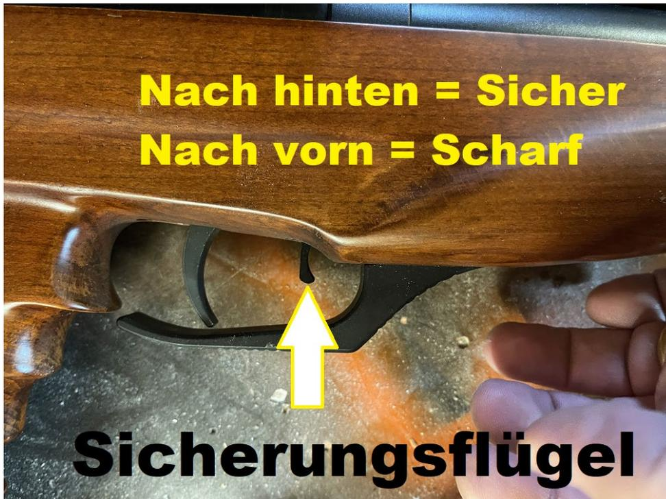
Achtung: Verwenden Sie die Sicherung nur bei gespannter Waffe! Bei entspannter Waffe kann die Sicherung NICHT eingelegt werden.
