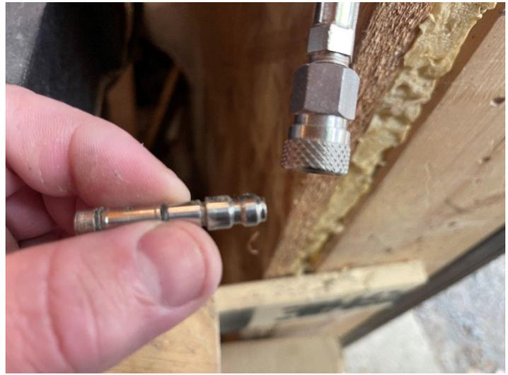
Füllstutzen an die Druckluftquelle anstecken
